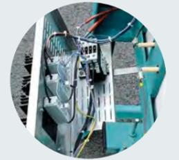
Kompakte, ausklappbare Elektrik in der Ofenrückwand
