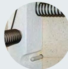
Thermoelement, geschützt eingebaut
